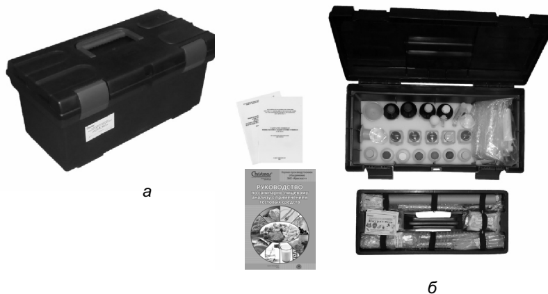
Рисунок 1. Санитарно-пищевая мини-экспресс-лаборатория «СПЭЛ», в закрытом (а) и раскрытом (б) виде.
