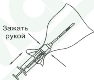
Рис. 17. Использование полиэтиленового мешка в качестве камеры при анализе модельных воздушных смесей с применением индикаторной трубки
