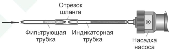
Рис. 11. Схема соединения трубок с аспиратором типа НП-3М
